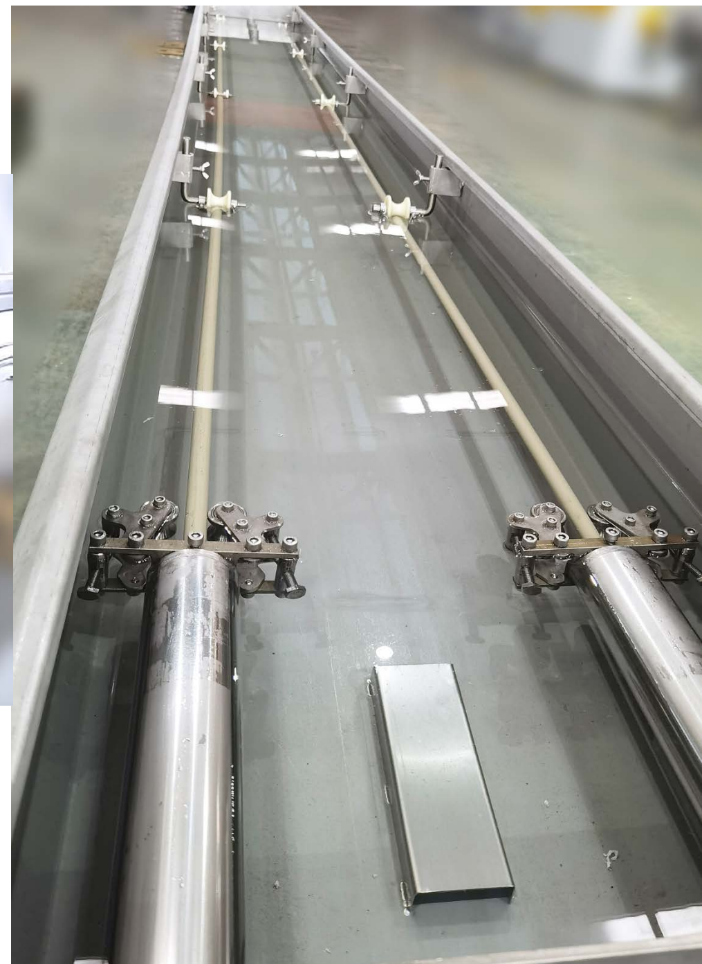
Охлаждающая ванна для двух труб, длина 6 метров × 3 комплекта
