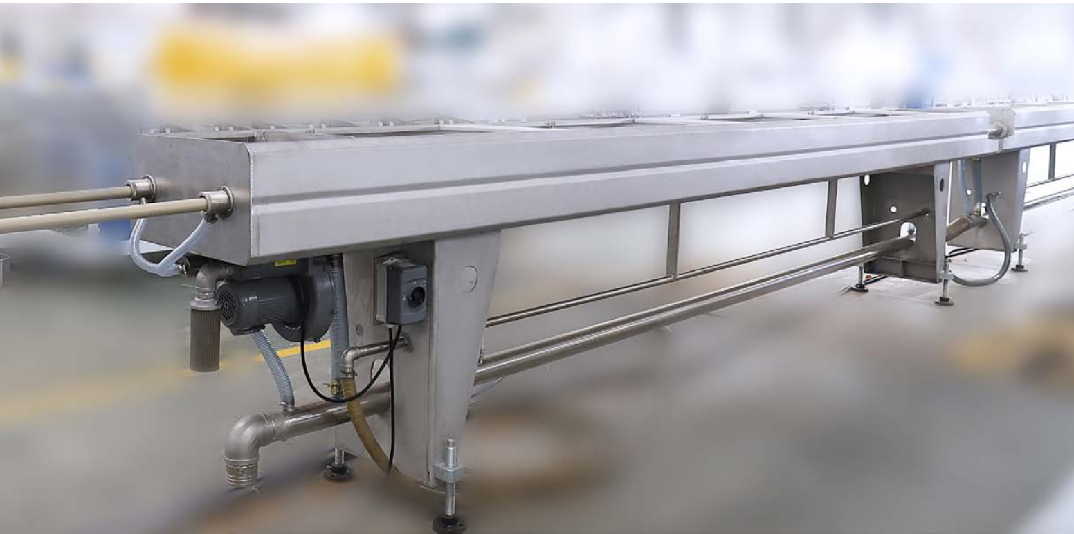
Охлаждающая ванна для двух труб, длина 6 метров × 3 комплекта
