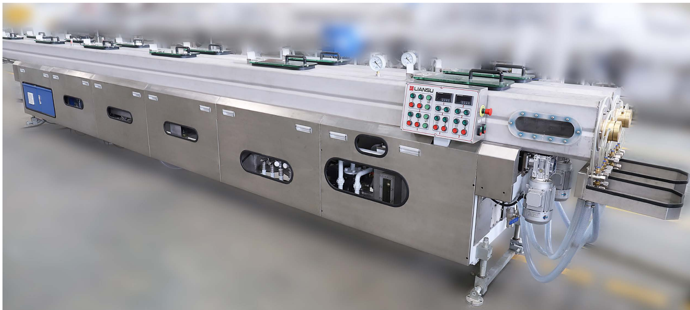
Вакуумная ванна: 9-метровый двойной бак, инверторный привод, управление с обратной связью. Преимущество: автоматический контроль вакуума, энергосбережение.
